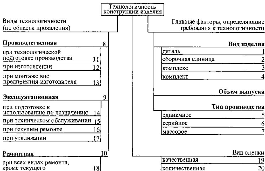
Рис. 1. Виды технологичности, главные факторы, определяющие требования к технологичности конструкции, и виды оценки технологичности
